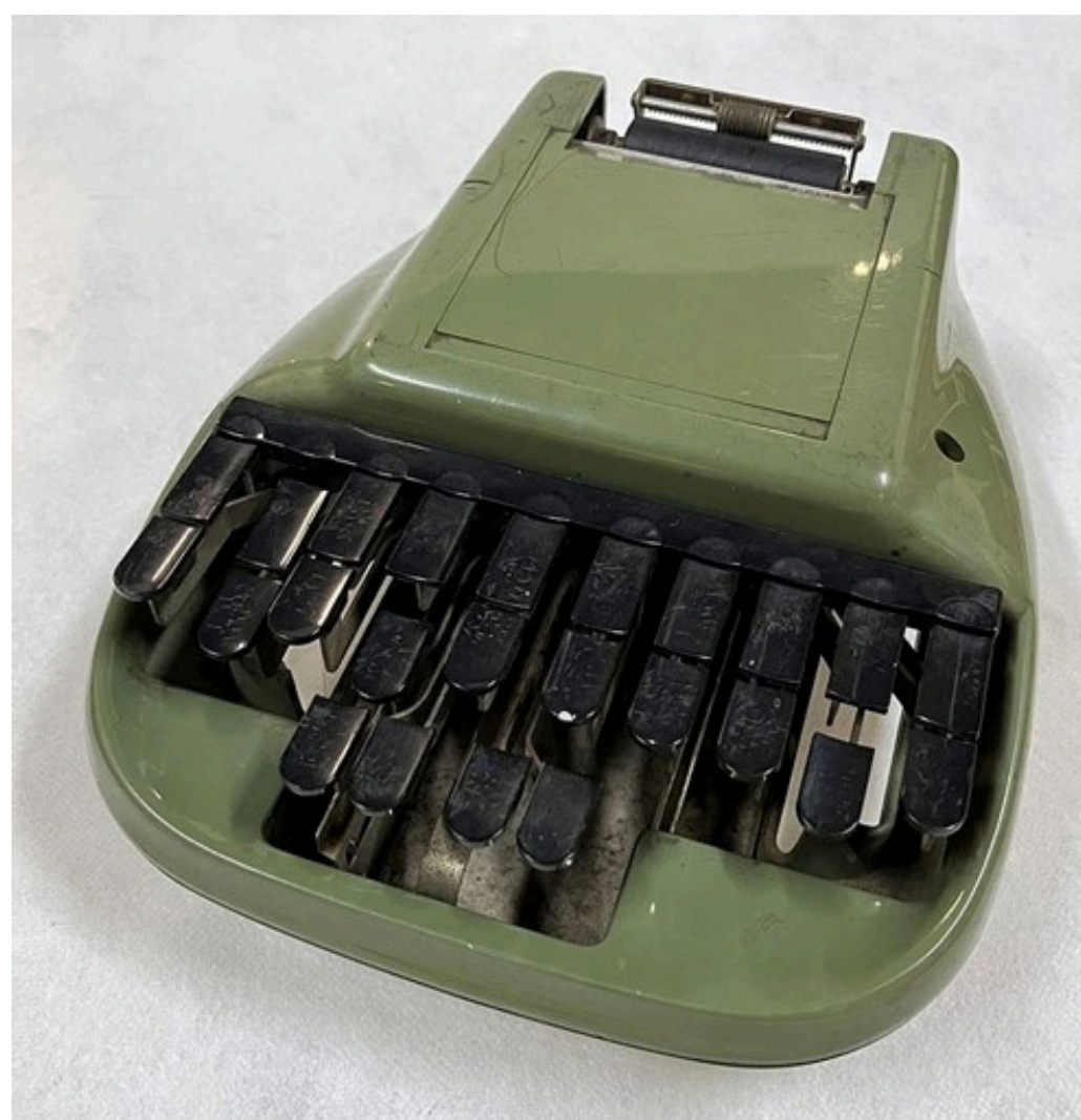
Imagem 04: Estenótipo Secretarial Model Shorthand Machine fabricado por Stenograph Fonte: Centro de Memória da Etec Getúlio Vargas
