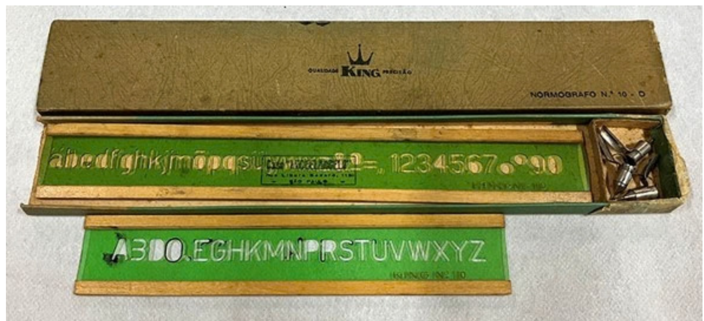
Imagem 11: Normógrafo número 10 King Fonte: Centro de Memória da Etec Getúlio Vargas
